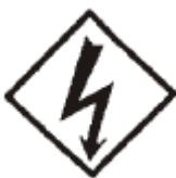
Не пренебрегайте заземлением нагрузочного оборудования даже если генератор оснащен защитным устройством от утечек энергии. Если нет надежного заземления электрический ток может пройти сквозь тела человека при утечке энергии и привести к серьезному ранению. Обеспечьте надежное заземления генератора и нагрузочного оборудования.
