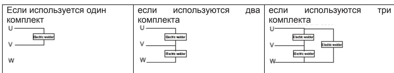
Входная мощность одного электрического сварочного агрегата должна быть ниже 1/3 выходной мощности генератора. Перегрузка приводит к повреждению.
